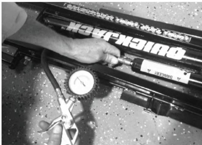
**3.** Lorsque la pression est comprise entre 40 et 50 psi / 2,75 à 3,4 BAR, retirez la pompe ou le compresseur d'air.
