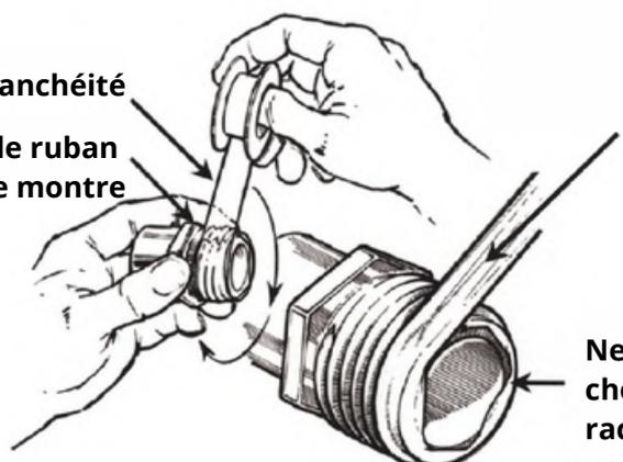
Faites seulement 2 à 3 tours superposés de ruban d'étanchéité, jusqu'à ce que les filetages soient recouverts
